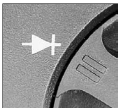
Rysunek 10.13. Oznaczenie trybu badania diod na mierniku uniwersalnym
